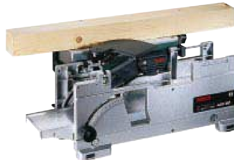
Das einfache Untergestell (oben) eignet sich zum Bearbeiten kleinerer Werkstücke, die Stationäreinrichtung (links) für Abrichten und präzises Dickenhobeln.
