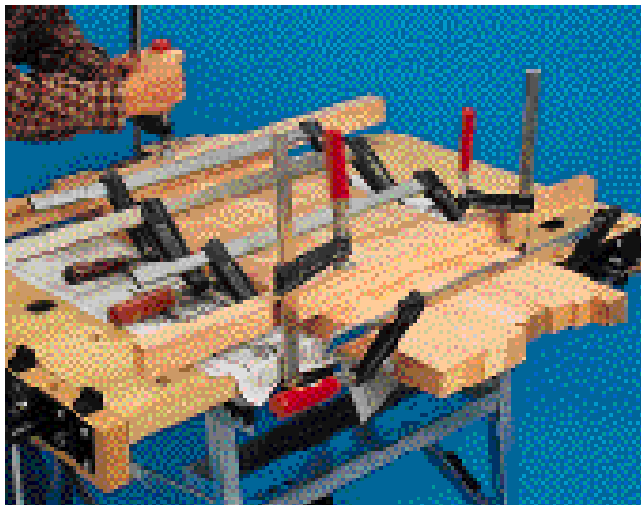
Aus allseitig gehobelten Leisten entstehen in der Werkstatt Leimholzplatten für den Möbelbau: Tische, Schränke oder Regalwangen und Regalböden.
